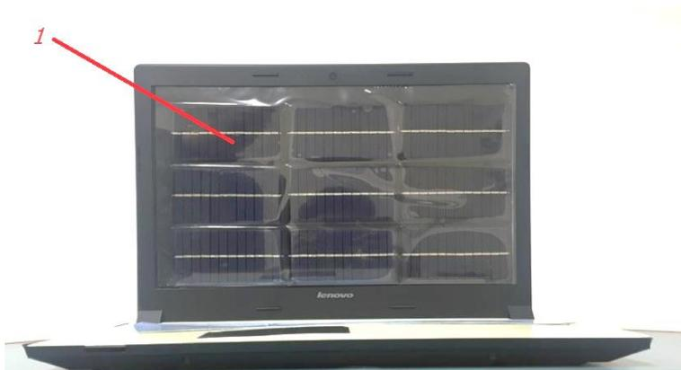
Рис. 1. ФЭЭН – вид спереди. 1- блок фотоэлектрических преобразователей
