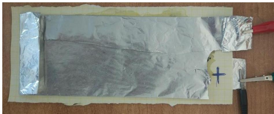
Рис. 2. Фото самодельного ионистора.
