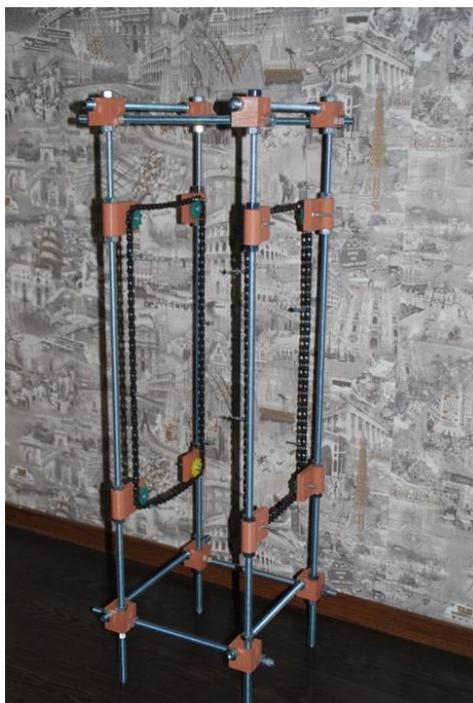
Рис. 5. Конструкция корпуса вертикальных грядок.
