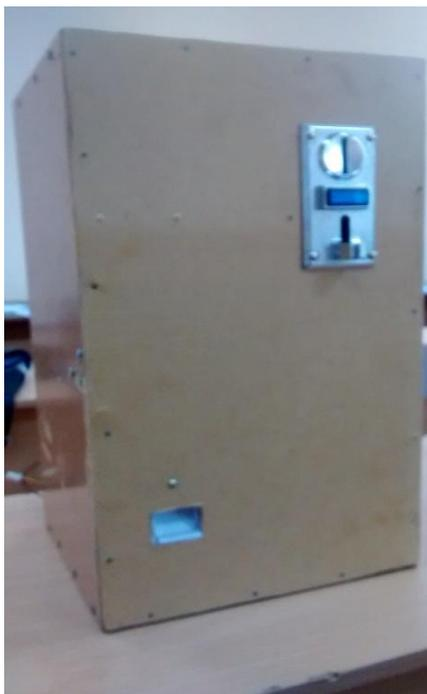
Рис. 3. Вид торгового автомата спереди. На передней панели расположен монетоприемник и отсек для получения товара
