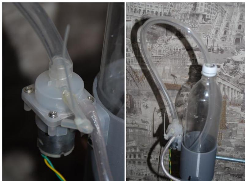
Рис. 10-11. Помпа для воды и Емкость для воды с силиконовой трубкой.
