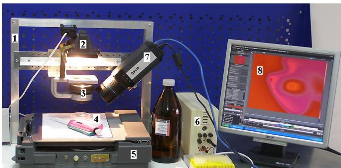
Схема установки: 1 штатив, 2 галогеновая лампа в кожухе, 3 линза, 4 подложка, 5 платформа с подвижным столиком, 6 источник питания лампы, 7 тепловизор, 8 компьютер.
