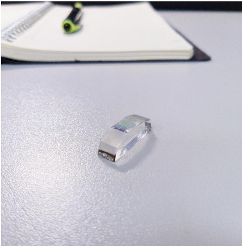
Рис. 1. Призма оптического смесителя
