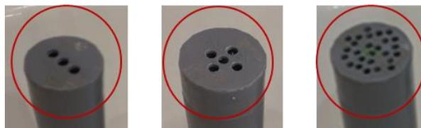
Рис. 2. Виды отверстий в нижней заглушке «супер ливера» диаметр 6 мм (слева); диаметр 5 мм (посередине); диаметр 4 мм (справа)
