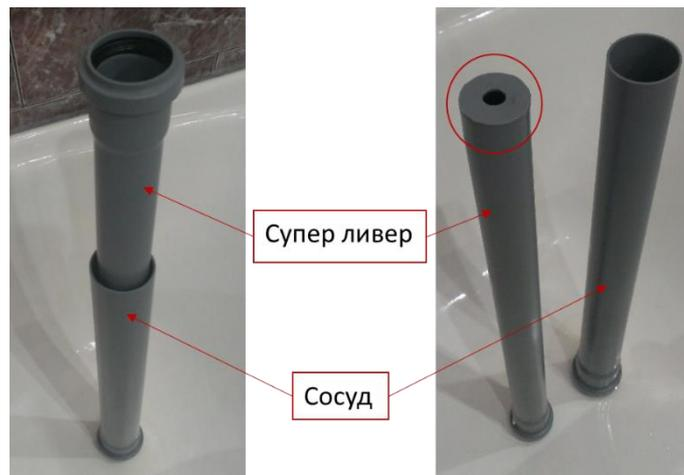
Рис. 1. Экспериментальный стенд: общий вид (слева); вид на отверстие в нижней заглушке «супер ливера» (справа)
