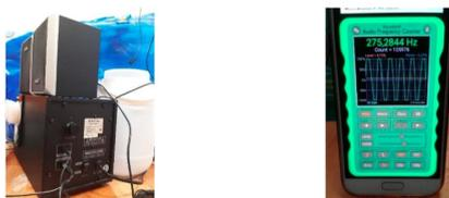
Рис. 1. Установка для создания явления акустического самовозбуждения в емкости (слева) и интерфейс программы Frequency Counter на смартфоне.
