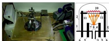
1. Опорная плита; 2. Вакуумный колпак; 3. Вакуумная магистраль; 4. Защитная сетка; 5 – 6. Токосводы испарителя материала и нагревателя подложки; 7. Испаритель; 8. Испаряемое вещество; 9. Подложка; 10. Нагреватель подложки; 11. Фиксаторы подложки; 12. Уплотнитель.
