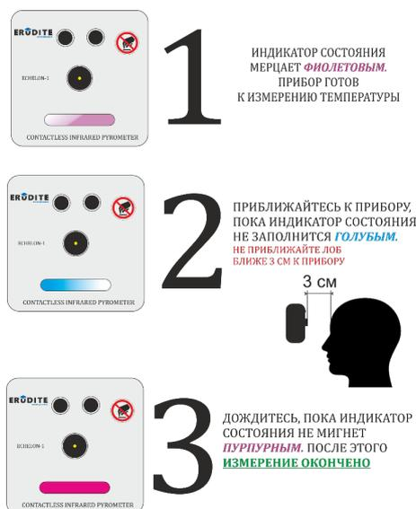
Рис. 2. Этапы измерения температуры с помощью «Эшелона-1»
