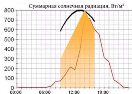
Рис. 2 Сравнение модели с графиками изменения мощности излучения Солнца
