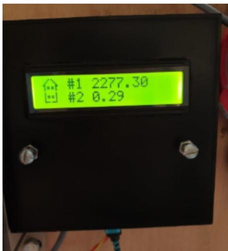
Рис. 2. Внешний вид устройства. На экране показания двух подключенных счетчиков — электричества №1 и воды №2
