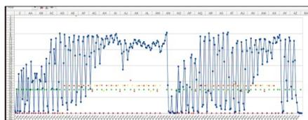
Рис.3. Графическое представление значений, полученных с фоторезистора
