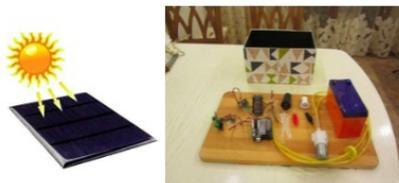
Рис. 2. Комплектующие: плата Arduino, датчик влажности почвы, мембранный насос, силовой ключ, LED индикатор, 2 кнопки, Trema Shield, коннектор PowerJack, аккумулятор 12В, преобразователь напряжения 12В->5В, солнечная батарея, датчик расстояния, фоторезистор, светодиоды
