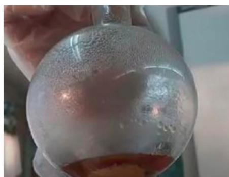
Рис. 5. Выпадение желтого осадка после кипячения экстракта с  $pH=8$
