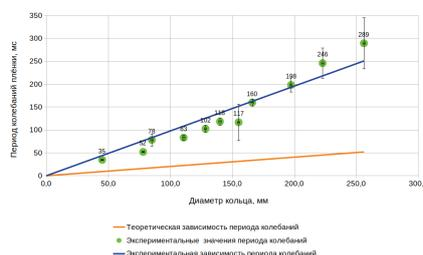
Рис.4. График зависимости периода колебаний мыльной плёнки от её диаметра
