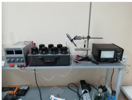
Рис.1 Снимок установки для получения никелевых плёнок
