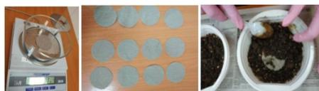
Рис. 3. Закладка опыта для определения целлюлазной активности почвы
