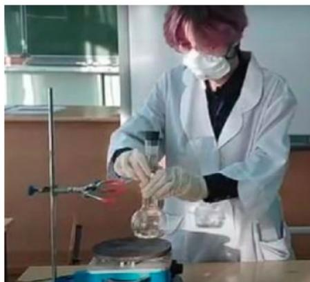
Рис. 1. Колба с измельченными высушенными стеблями борщевика и раствором соляной кислоты
