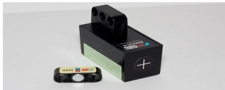
Рисунок 3. Магнитный датчик от компании Smartbricks
