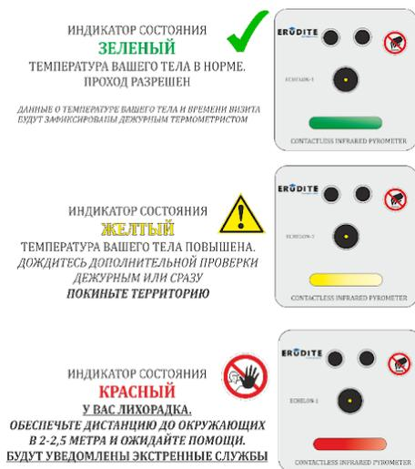
Рис. 3. Интерпретация результатов измерения температуры с помощью «Эшелон-1»
