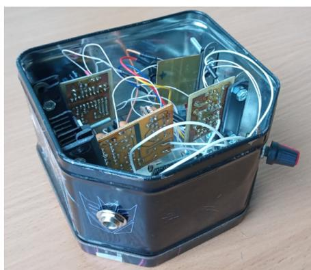
Рисунок 7. – усилителя после монтажа в корпус
