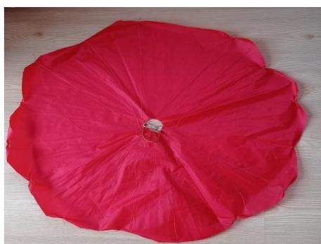
Рис. 3. Плоский купол, изготовленный из нейлона
