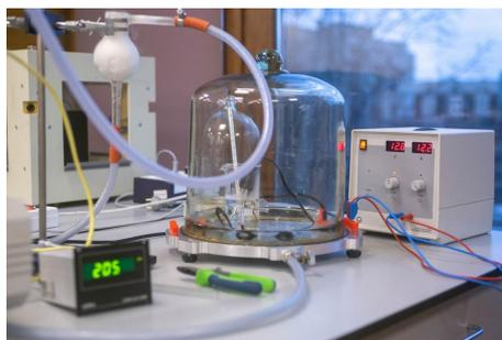
Рис.2 Замеры температуры кипения воды
