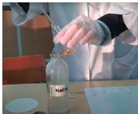
Рис. 4. Подщелачивание экстракта
