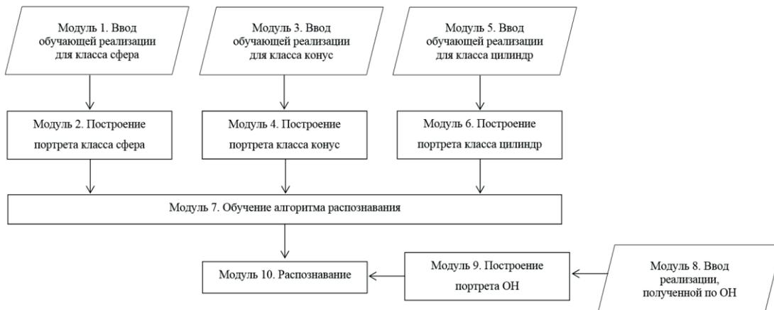
Рис. 1. Блок-схема модели функционирования алгоритмов распознавания осесимметричных объектов наблюдения по поляризационным признакам
