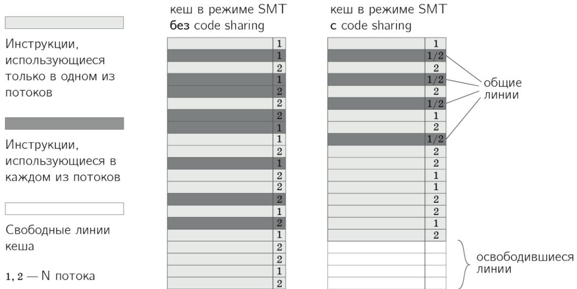
Рис. 1. Механизм увеличения эффективного размера кеша при использовании потоков общих линий
